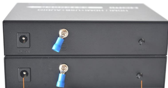
Порт питания постоянного тока 5 В, 2 А подключение к земле (защита от молнии) кнопка сброса
