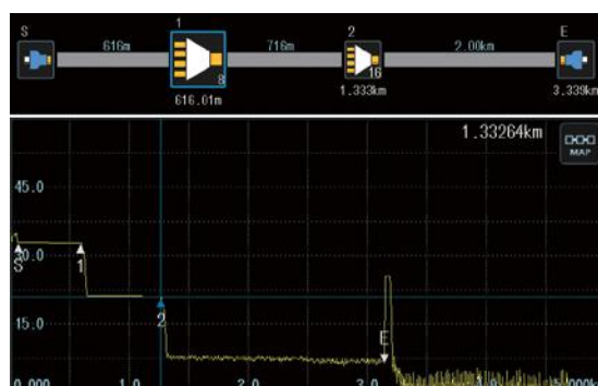
Пример измерения с разветвителем на 128 ветвей
